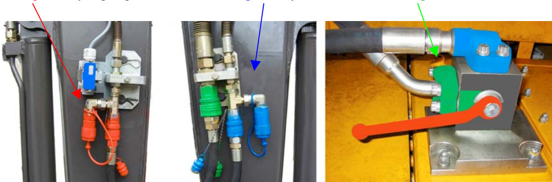
Bilde nr 1. Fargekoder slik gruppa har valgt å foreslå som standard: Gravearm på VOLVO kompaktgraver, venstre side rød og El kontakt, høyre side blå/grønn. Velgeventil for hammer 1 og 2 på O&K graver.
